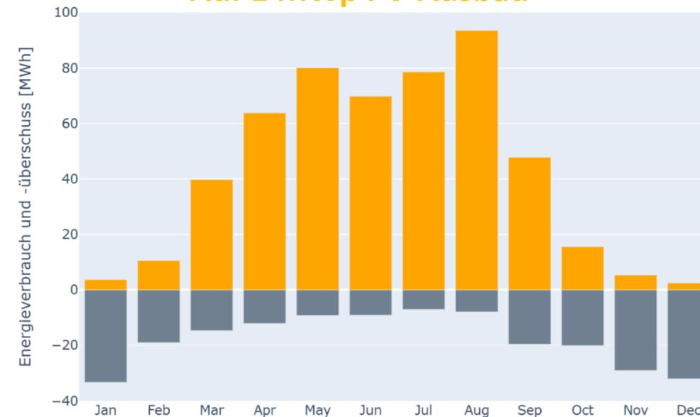
Legende: ■ Netzbezug mit PV-Ausbau[MWh] ■ Stromüberschuss[MWh]
